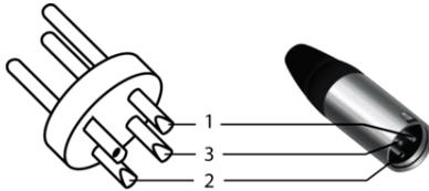
XLR-/6,35-mm-Klinken-Kombibuchsen dienen als Signaleingang am Sender. Zeichnung und Tabelle zeigen die XLR-Pinbelegung (symmetrische Beschaltung) und die Belegung eines passenden Klinkensteckers.
