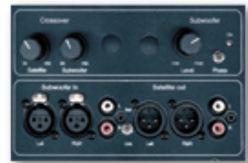
Kontroll Panel und Anschlüsse des Sub1 Verstärkers
