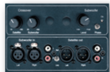
Rückwärtiges Kontrollpanel und Anschlüsse des SubP Verstärkers
