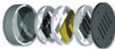
Konstruktiver Aufbau des A.R.T. Hochtöners mit Neodymmagneten und magnetischen Rückschluß, (=komplette Schirmung)
