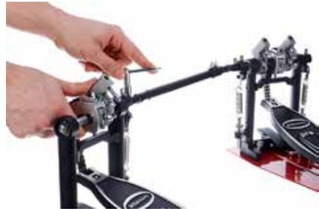
Schritt 3: Kette an der Fußmaschine (rechts) spannen
