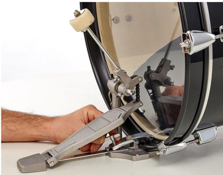
Ahora se puede montar y fijar el pedal de bombo con ayuda de la garra prevista en el aro tensor. Para evitar que se dañe el aro, pegue una tira de cinta adhesiva en el punto de fijación.
