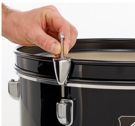
A continuación, apriete los 6 tornillos uniformemente en estrella con la fuerza de las manos. No hace falta tensar los tornillos en ese momento, pues la afinación del parche se efectuará finalizado el montaje.
