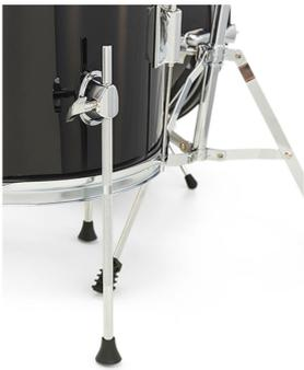
Inserte los pies en los soportes del tom de piso. Los pies "delanteros" se fijan en una posición central, aproximadamente, y situando el casco horizontalmente para ello. El pie que va dirigido hacia el baterista se posiciona y se fija luego poniendo el tom en la posición de tocar. Sujete el casco con una mano y apriete los tornillos de sujeción con la otra.
