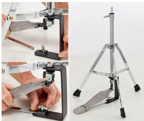
Introduzca la varilla plana debajo del pedal hacia adelante en el orificio y fíjela con el tornillo, igual que en el caso del pedal de bombo.
