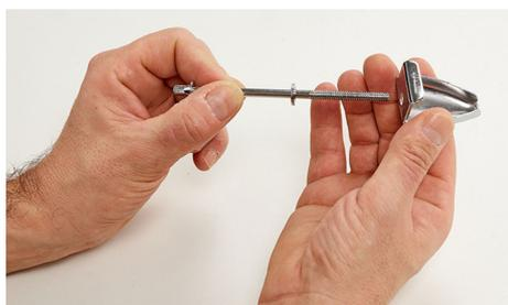
Procedimiento: Ponga primero la arandela y luego la garra tensora en el tornillo tensor. Se requieren 6 tornillos de cabeza cuadrada por lado.
