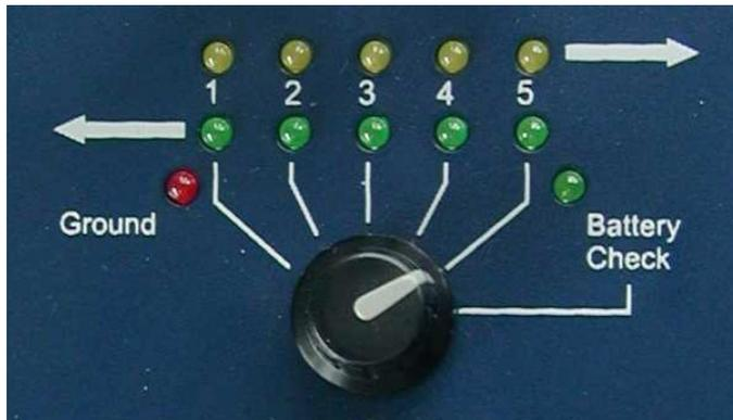
Abb.: Der Drehschalter und die LED – Anzeige des AHMCT8
