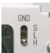
Der Erdfreischalter, oder auch Groundlift, hat die Aufgabe, den Pin 1 des XLR-Ausgangs (Masse) erdfrei zu schalten. Die Schutzerde wird dabei selbstverständlich nicht unterbrochen. Dieser Schalter kann bei Brummproblemen, wie sie bei Differentialunterschieden entstehen, Abhilfe schaffen.
