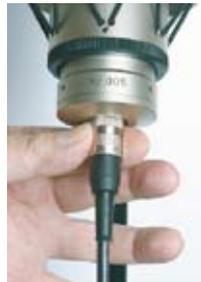
Prüfen Sie bitte zunächst alle Kabel auf Schäden und vergewissern Sie sich, dass das Netzteil ausgeschaltet ist. Verbinden Sie nun zunächst Mikrofon mit Netzteil, indem Sie die achtpoligen Tuchelbuchsen in die Tuchelstecker stecken (Führungsnut beachten) und die Überwurfhülsen handfest verschrauben. Dies verhindert eventuelle Brummstörungen.
