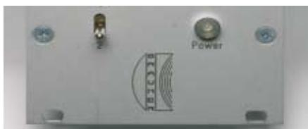
Beim VMA befindet sich an der Stelle des 10 dB-Dämpfungsschalters der Wahlschalter für die Klangcharakteristik. Die untere Position entspricht dem Klang des VM1 (hohe und gleichmäßige Durchzeichnung über den gesamten Frequenzbereich), die obere dem VMX (feine und vergleichbar weichere Abbildung der Höhen, sowie leichte Betonung der oberen Mitten und Tiefen).
