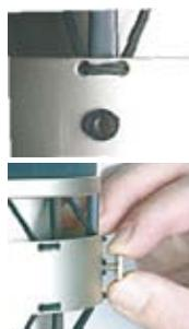
Um den mitgelieferten Windschutz an der Aufhängung anzubringen, schrauben Sie zunächst die beiden Rändelschrauben aus den Gewinden am Windschutz. Setzen Sie ihn nun so auf den Außenring der Aufhängung, dass die Haltestege des Windschutzes im inneren Ring der Spinne gleichauf mit den dortigen, mit schwarzen Kunststoffringen umrandeten, Gewindelöchern liegen. Arretieren Sie jetzt Spinne und Windschutz mit den Rändelschrauben, so dass beide fest und ohne Spiel verbunden sind.
