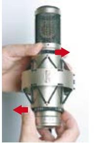
Sollten Sie das Gefühl haben, dass das Mikrofon schief in der Spinne steht, so haben Sie wahrscheinlich die beiden Klemmringe in die genau falsche Richtung festgedreht.
