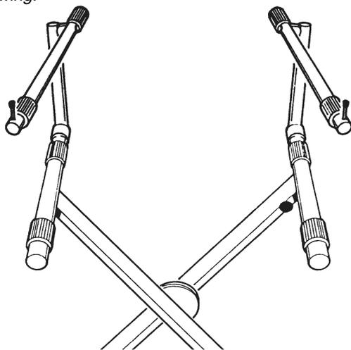
Rastschelle 1 **bis zum Anschlag** über das Keyboardständer-Auflagerohr schieben und mittels Innensechskantschraube 3 und Sicherungsmutter 2 mit Innensechskantschlüssel 4 **fest** fixieren- siehe Abb.
