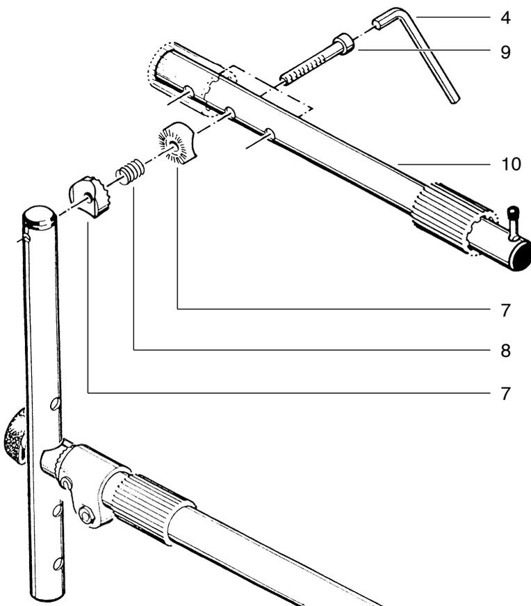
Auflagerohr 10 in gewünschter Position mittels Innensechskantschraube 9, Rastscheiben 7 (2 Stück) und Feder 8 mit Innensechskantschlüssel 4 an Verbindungsrohr befestigen- siehe Abb.
