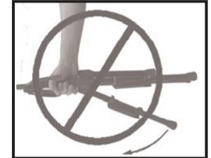
2. Der Auszug der Instrumentenauflage funktioniert nur, wenn die Verlängerung winkelig nach oben angehoben wird. (Memphis 20 und 30)
