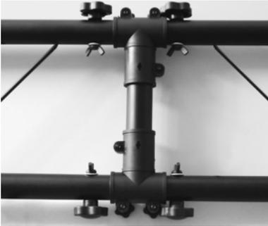
4. ➤ Stecken Sie das zweite Traversenstück auf das offene Ende auf und verschrauben Sie es.
