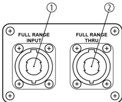
1, 2 Conexiones con cableados en paralelo (Speaker Twist)
