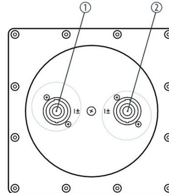
1, 2 Parallel verdrahtete NL4-Anschlüsse (1+/1– zum Bass; 2+/ 2– durchverbunden)
