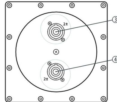
3, 4 Parallel verdrahtete NL4-Anschlüsse (2+/2- zum Bass; 1+/1- durchverbunden)
