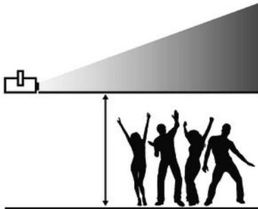
Zur Einhaltung der Grenzwerte für maximale Bestrahlung (MZB-Grenzwert für die ungefährliche Bestrahlung des Auges oder der Haut mit einem Laser) muss das Gerät nach der in Deutschland gültigen BGV-B2 in einer Höhe von mindestens 2,7 m installiert werden.
