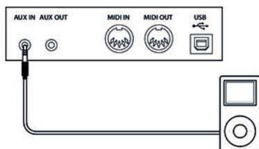
Por medio del terminal *[AUX IN]*, Vd. puede conectar un reproductor de CD o MP3, por ejemplo, para reproducir y acompañar sus piezas propias a través de los altavoces del piano digital. Conecte el terminal *[AUX IN]* del piano por medio de un cable adecuado con la salida del equipo externo.
