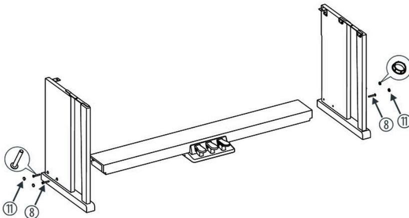
3. ➤ Sitúe la caja de pedales entre los laterales, fijando los mismos por medio de dos tornillos M6 × 40 en ambos lados de la caja.
