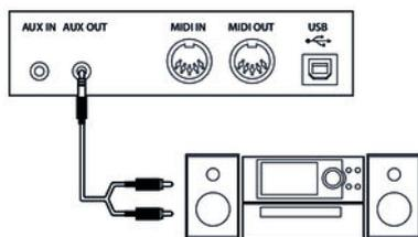
Por medio del terminal *[AUX OUT]*, Vd. puede conectar un amplificador, otros equipos de audio, un mezclador o un equipo de grabación con el piano digital. Conecte el terminal *[AUX OUT]* del piano por medio de un cable adecuado con la entrada del equipo externo.
