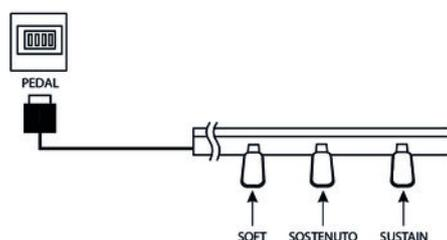
1. ➤ Conecte el pedal de pie con el terminal previsto en la parte inferior de la caja de pedales.
