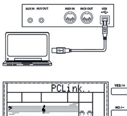
Primero, inicie su ordenador. Conecte la conexión USB situada en la parte posterior del piano digital con la conexión USB de su ordenador mediante un cable USB estándar (no incluido en la entrega). A continuación, encienda el piano digital.
