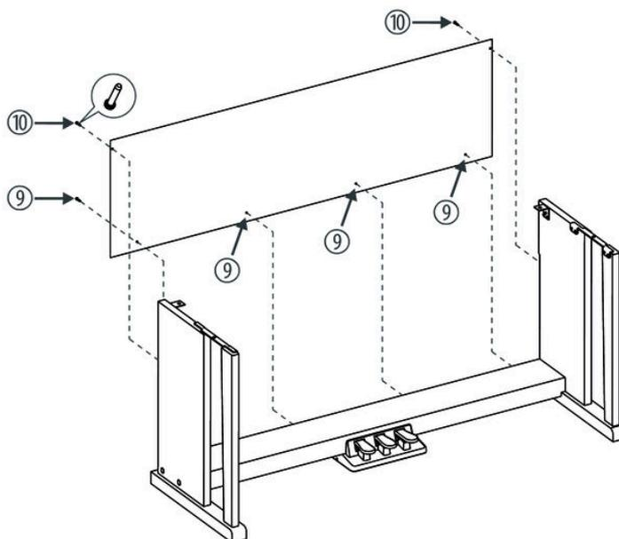
4. ➤ Monte el panel de fondo con cuatro tornillos M4 × 5 y con dos tornillos M6 × 12 en la caja de pedales y en la cara posterior de los laterales.
