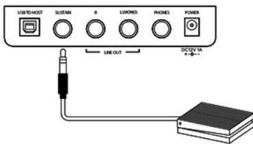
Verbinden Sie das mitgelieferte Sustain-Pedal mit dem vorgesehenen Anschluss auf der Rückseite des Geräts.
