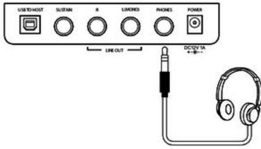
Der Kopfhörerausgang befindet sich auf der Rückseite des Geräts.
