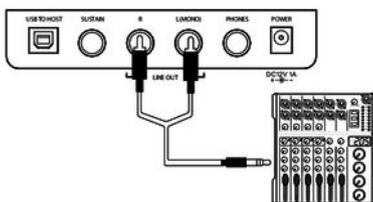
Über die Buchsen [LINE OUT] können Sie das Digitalpiano an einen Verstärker, eine Stereoanlage, ein Mischpult oder ein Aufnahmegerät anschließen. Stecken Sie ein Ende des Audiokabels in die Buchsen [LINE OUT] im Anschlusskasten des Digitalpianos und das andere Ende in den Eingang des entsprechenden Audiogeräts.
