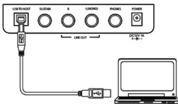
Über diesen Ausgang werden die vom Digitalpiano erzeugten MIDI-Daten an einen PC übertragen (MIDI steht für „Musical Instrument Digital Interface“ und ermöglicht als weltweiter Standard das elektronische Zusammenspiel verschiedenster Instrumente und Soundmodule).
