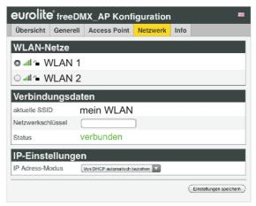
Wählen Sie im Menüpunkt "Netzwerk" das WLAN-Netz, in das das freeDMX AP eingebunden werden
