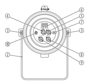
1 COB LED (100 W) 2 Bügel zum Aufhängen oder Aufstellen 3 Feststellschrauben für den Bügel 4 [DMX IN] **DMX-Eingang** 5 [DMX OUT] **DMX-Ausgang** 6 Display [MENU] Aktiviert das Hauptmenü bzw. ein Untermenü.  $\blacktriangle$ Navigiert in einer Menüliste nach oben. Erhöht den angezeigten Wert um eins. Navigiert in einer Menüliste nach unten. Verringert den angezeigten Wert um eins.
