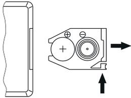
Drücken Sie die Sperre des Batteriehalters zur Gehäusemitte und ziehen Sie den Batteriehalter wie eine Schublade heraus. Legen Sie die Batterien polaritätsrichtig gemäß der Markierung auf der Fernbedienung ein. Schieben Sie den Batteriehalter zurück in die Fernbedienung, bis er einrastet.
