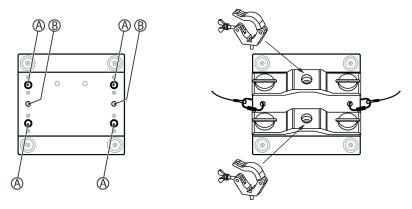
Die Quick-Lock-Aufnahmen an der Gehäuseunterseite (A) dienen zur sicheren Montage der mitgelieferten Haltebügel. Daran können Flugadapter (Half Coupler, Trigger Clamps, C-Haken u.ä.) befestigt werden. Sicherheitsfangseile werden durch die Sicherheitsösen (B) an der Gehäuseunterseite geführt.
