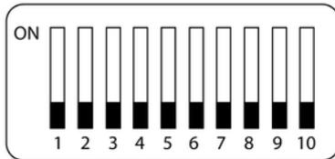
Stellen Sie den DIP-Schalter 10 in die Position "OFF", um den Stand-Alone-Betrieb zu aktivieren.
