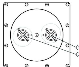
1, 2 Terminales NL4 cableados en paralelo (señal de baja frecuencia vía 1+/1-, señal directa vía 2+/ 2-)
