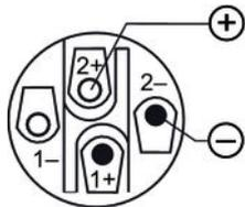
La ilustración muestra la asignación del conector NL4 con mecanismo de cierre.
