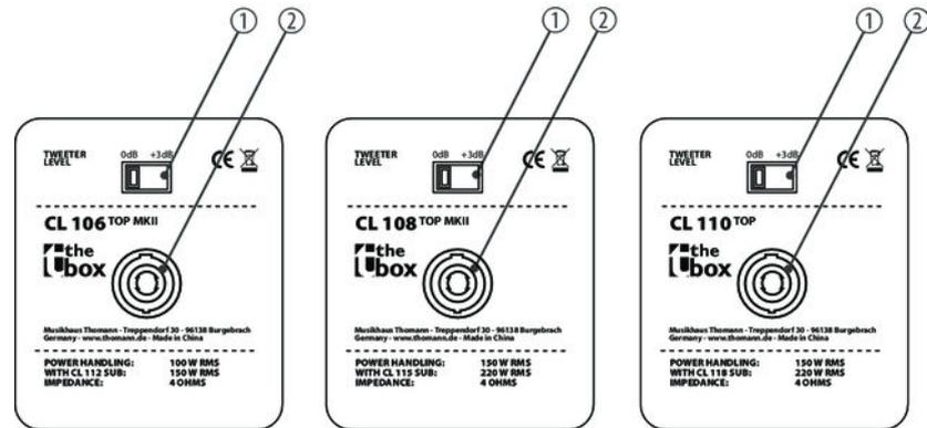
1 Schiebeschalter zur Pegelanhebung um +3 dB ab 5 kHz
