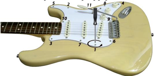
Anschließend schrauben Sie das Pickguard mit den neuen Fender Schrauben in der gezeigten Reihenfolge im Uhrzeigersinn wieder fest.
