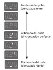
La comprobación de tiempo termina automáticamente y los resultados se muestran en la pantalla.
