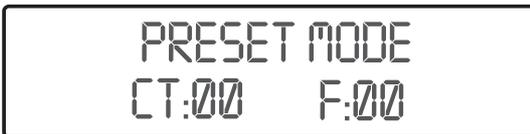
Drücken Sie die ENTER-Taste um die Flash-Geschwindigkeit zu wählen. Über die UP- oder DOWN-Taste können Sie die gewünschten Werte eingeben.
