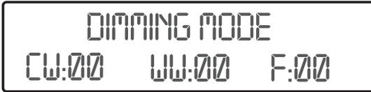
Drücken Sie die ENTER-Taste um jeweils die Helligkeit der kaltweißen (CW) und der warmweißen (WW) LEDs und die Flash-Geschwindigkeit zu wählen. Über die UP- oder DOWN-Taste können Sie die gewünschten Werte eingeben.
