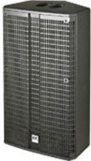
12"/1" Modell im Multifunktionsgehäuse mit dem höchsten Maximalschalldruck (135dB MAX SPL Peak), umschaltbarem Filter für Topteil-Anforderungen (besonders hoher Reichweite), im Verbund mit dem Linear Sub 2000/2000 A für Systemanwendungen. Die L5 112 XA eignet sich hervorragend auch als Monitor mit viel „Gain before Feedback“, das drehbare 60° x 40° CD-Horn erzeugt dabei eine vorbildliche Abstrahlung.
