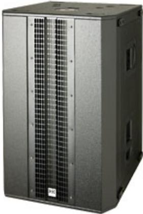
Der Linear Sub 2000 / 2000 A ist als doppelter Bandpass 6. Ordnung konzipiert und ideal zur Erweiterung der L5-Toppteile geeignet. Er liefert tief beeindruckende Bässe im Nutzbereich 50-120 Hz. In ihm werkeln zwei 12" Langhub-Woofer mit 2,5" Schwingspule (modernes Kühlungssystem und doppelte Zentrierspinne für besonders exakte Führung). Als Antrieb dient eine neu entwickelte 1200 Watt Class-D Endstufe.
