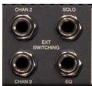
Es gibt vier externe Schaltbuchsen (EXT SWITCHING - 6,3mm Klinkenbuchsen), um die Kanalschaltung, den EQ und die SOLO Funktion über einen externen Switcher (z.B. MIDI Controller) fernzusteuern. Dies kann gerade bei großen Setups mit verschiedenen Effektgeräten auf der Bühne von großem Vorteil sein. Die externen Schaltbuchsen reagieren auf dauerhaften (latching) „Tip to Ground“.
