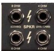
Es gibt zwei 8Ohm und zwei 4Ohm Lautsprecheranschlüsse (SPEAKER OUTPUTS), womit viele verschiedene Lautsprecher setups optimal angeschlossen werden können. Der MARK V reagiert nicht empfindlich auf Fehlanpassungen bei der Impedanz, so ist es möglich mit verschiedenen Impedanzen zu experimentieren. Lediglich bei Unterschreitung der Impedanz wird die Lebensdauer der Endstufenröhren verringert (z.B. 20Ohm Last am 4 Ohm Ausgang - oder auch 40Ohm Last am 80hm Ausgang)
