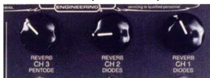
Jeder Kanal hat seine eigene Intensitätsregelung für den eingebauten, röhrengetriebenen Federhall. Außerdem schaltbar über den mitgelieferten Fußschalter
