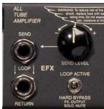
Der EFFECT LOOP ist mit einer HARD BYPASS Funktion ausgestattet. Bei HARD BYPASS ist der EFFECT LOOP, die OUTPUT- und die SOLO Funktion außer Betrieb. Nebenbei wird eine komplette Vorstufenröhre aus dem Signalkreis herausgenommen, was gerade für Puristen im Studio von Interesse sein kann.
