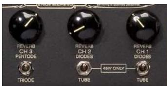
Drei individuelle REVERB (Hall) Regler erlauben einen Abgleich des Hallanteils pro Kanal. Der Hall des MARK V ist eine kompromisslose Vollröhrenauführung mit hervorragendem Klang. Der REVERB Effekt kann auch über den Fußschalter ein- und ausgeschaltet werden.
