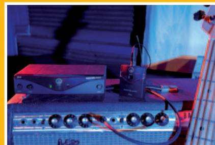
„Sichtkontakt ist Funkkontakt“ – stell den Empfänger immer freistehend auf und trag den Taschensender am Gitarrengurt oder gut sichtbar außen!
