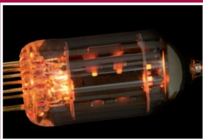
Das Doppel-Trioden-System der einge-setzten ECC 83 Röhre des AKG P 820 Tube sorgt für die Verstärkung der geradzahli-gen, harmonischen Obertonschwingungen und damit für einen vollen, „warmen“ Sound.
