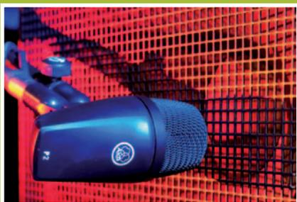
Für das Amp Miking stelle das Mikrofon so nahe wie möglich zum Lautsprecher. Je weiter Du zum Membranmittelpunkt kommst, desto höhenbetonter wird der Sound.
