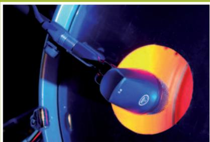
Profitipp aus dem AKG-Akustik-Labor: Wir haben das P 2 mit vielen verschiedenen Bassdrums getestet. Für den absolut besten Sound erhöhst Du am EQ (z. B. am Mixer) bei 70 Hz um +3 dB und reduzierst bei 700 Hz um -3 dB.
