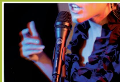
Im regelmäßigen Bühneneinsatz kann der Klang eines Mikrofons dumpfer werden. Der Grund dafür sind feinste Verschmutzungen im integrierten Windschutz. Mit etwas Pflege klingt das Mikrofon so gut wie neu: Nimm den Windschutz aus der Gitterkappe heraus und reinige diesen mit etwas Seifenwasser. Danach lass den Windschutz trocknen und setze das Mikrofon wieder zusammen. Das Ergebnis: einfach erfrischend!
