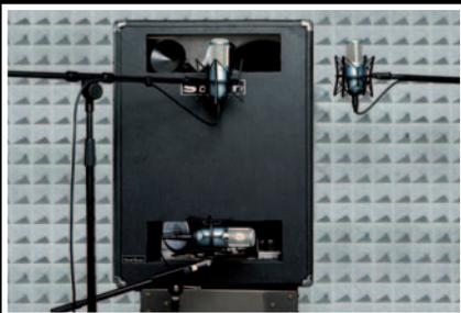
Eine besonders räumliche Wirkung erzielst Du mit der Abnahme von drei Mikrofonen. Ein Mikrofon richtest Du im Abstand von etwa 20 cm auf das Tieftonsystem. Zwei weitere Mikrofone platziere mit breitem Öffnungswinkel in etwa 20 cm Abstand auf das Hochtonsystem.
