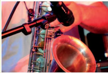
Das Mikrofon immer nahe an der Schallquelle platzieren! So werden möglichst wenige andere Schallquellen (Störgeräusche) von der Bühne mitaufgenommen.
