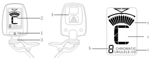
1. Interruptor de encendido/apagado (mantener pulsado por 2 seg.) & selector "afinación"
