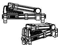
2. Öffnen Sie den Ständer und entriegeln Sie die beiden Arme.
