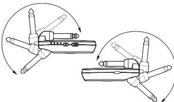
Stecken Sie den Sender in die 6,3-mm-Klinkenbuchse des Instruments, dessen Signal übertragen werden sollen. Der Sender blinkt fünfmal. Während der Übertragung leuchtet die LED-Anzeige.
