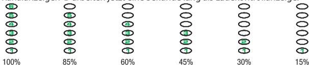
Sinkt der Ladezustand unter ca. 10 %, blinkt der RF-Status-LED-Ring ④ zweimal rot und das Gerät schaltet sich automatisch ab.
