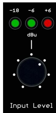
Hierzu wird der 'Input Level' so weit aufgedreht, dass die beiden grünen LEDs mehr, oder weniger kontinuierlich leuchten. Blinkt bei stärkerem Anschlag rote LED kurz auf, ist das o.k.; es steht immer noch genug 'Headroom' zur Verfügung. Rotes 'Dauerlicht' sollte allerdings nicht sein.
