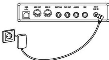
Branchez le câble à la sortie du bloc d'alimentation à la prise d'entrée [DC IN] à l'arrière de l'appareil. Branchez ensuite la fiche du câble d'alimentation électrique dans une prise électrique raccordée dans les règles de l'art.
