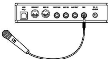
La prise [*MIC*] permet de raccorder un micro dynamique au clavier (prise jack en 6,3 mm).
