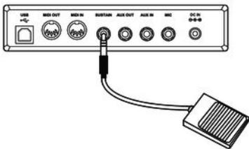
La prise [*SUSTAIN*] permet de raccorder une pédale Sustain au clavier.
