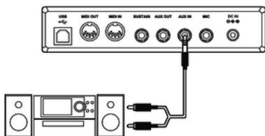
La prise [AUX OUT], vous permet de raccorder le clavier à un amplificateur, une chaîne hi-fi, un pupitre de mixage ou un appareil enregistreur. Branchez une extrémité du câble audio dans la prise [AUX OUT] à l'arrière du clavier et l'autre extrémité dans l'entrée de l'appareil audio correspondant.
