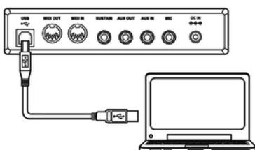
Le port USB permet de raccorder le clavier à un PC pour échanger des données. De plus s'y effectue aussi le transfert de fichiers MIDI.
