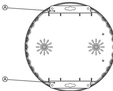
A Brides de montage pour la fixation murale ou au plafond de l'appareil.
