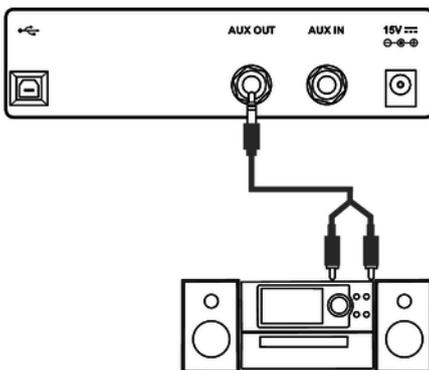
Vous pouvez raccorder le piano numérique à un amplificateur, une chaîne hi-fi, un pupitre de mixage ou un appareil enregistreur via la prise AUX/OUT. Branchez une extrémité du câble audio dans la prise AUX OUT à l'arrière du piano numérique et l'autre extrémité dans l'entrée de l'appareil audio correspondant.
