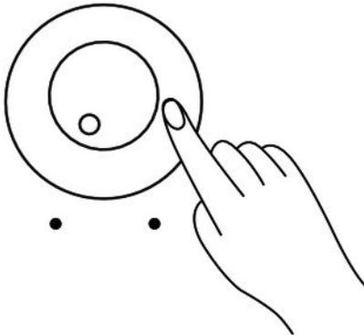
Tournez le bouton de réglage du volume sur « minimum » dans le sens contraire des aiguilles d'une montre avant de connecter le piano numérique à l'alimentation électrique ou à d'autres appareils pour protéger les haut-parleurs.
