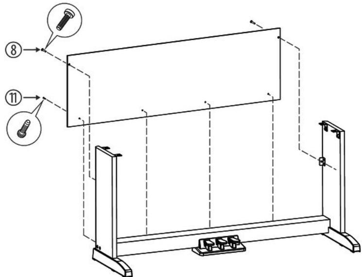
Fixez la paroi arrière avec quatre vis 4 × 15 au pédalier et avec deux vis M6 × 18 à l'arrière des étriers de fixation.
