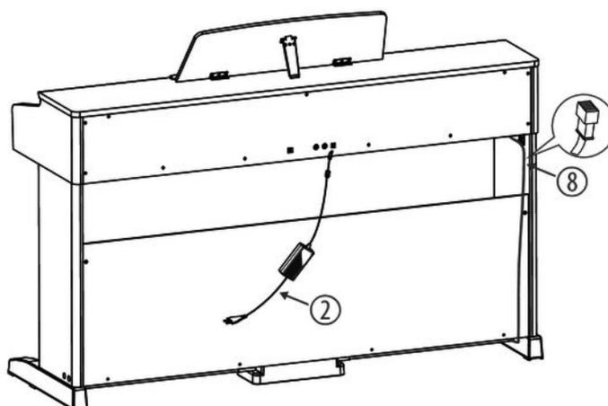
Branchez la fiche DIN du câble de la pédale dans la prise prévue à cet effet sur la face inférieure du boîtier du piano numérique. Fixez le câble au châssis et déplacez le piano numérique à l'endroit souhaité.
