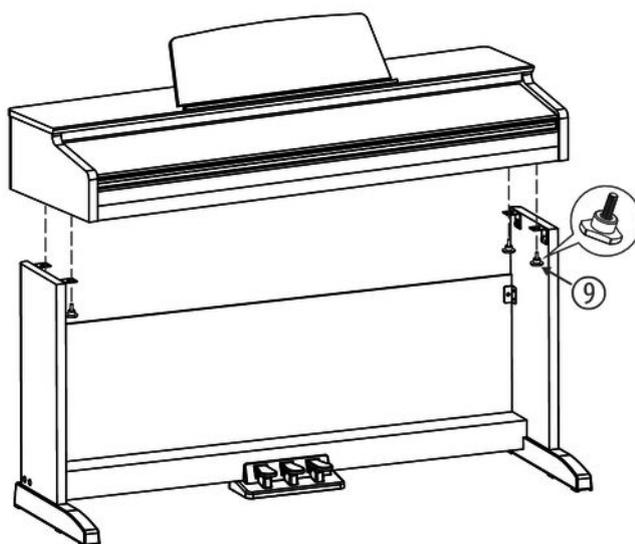
Placez le corps du piano numérique sur le châssis et fixez-le au moyen des quatre molettes.
