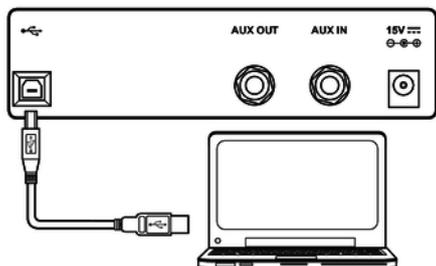
Le port USB permet de raccorder le piano numérique à un PC pour échanger des données. De plus, le transfert de données MIDI s'effectue également ici.
