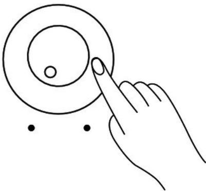
Réglez un niveau de volume agréable pour la lecture et les exercices avec le bouton rotatif [VOLUME]. Tournez le régleur dans le sens des aiguilles d'une montre pour augmenter le volume. Tournez-le dans le sens inverse pour diminuer le volume.
