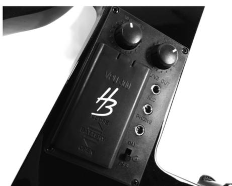
Remplacez si nécessaire les piles utilisées (affaiblissement du signal émetteur) ou à des intervalles réguliers.
