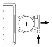
Déplacez le curseur sur le support de pile vers le milieu du boîtier et tirez le support à la manière d'un tiroir. Placez la pile à l'intérieur. La pile est placée correctement lorsque le pôle positif est orienté vers le fond du boîtier de la télécommande. Repoussez le support de pile dans la télécommande jusqu'à enclenchement.
