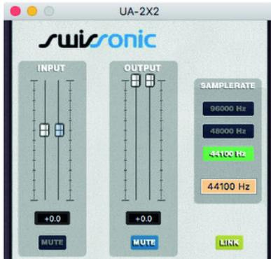
Le Control Panel sur l'ordinateur permet de commander l'interface audio.
