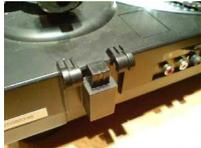
Abdeckung für Feder entsprechend positionieren
