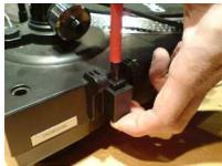
Feder spannen (dies erfordert etwas Kraft, da die Feder das Eigengewicht des Deckels halten muß)
