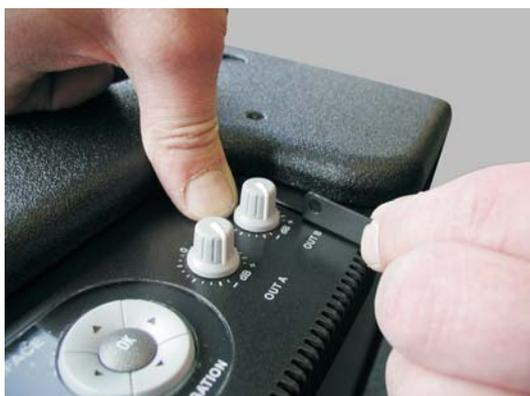
Nehmen Sie den rechten Montagewinkel und schieben Sie ihn, wie eben beschrieben, zwischen Elektronik-Chassis und Lautsprechergehäuse.
