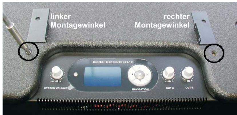
Legen Sie sich zunächst den linken und rechten Montagewinkel bereit und drehen Sie die beiden Schrauben auf der Oberseite Ihrer VSS 15/18 mit einem Schraubendreher (Torx 20) heraus.
