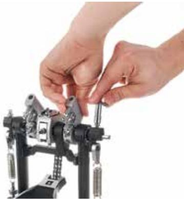
Schritt 4: Kette an der Fußmaschine (links) spannen
