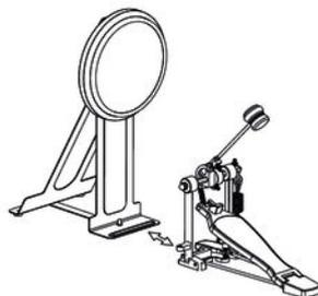
1. ➤ Rasten Sie die beiden Metallstangen in die vorgesehenen Bohrungen am Gestell der Fußmaschine ein.
