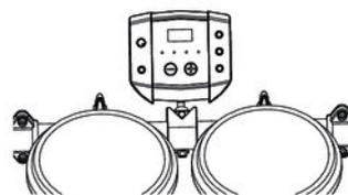
1. ➤ Setzen Sie das Drum-Modul auf Anschlag in die freie Klemme des Verbindungsrohrs.
