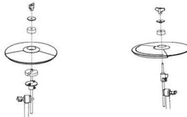
3. ➤ Schrauben Sie die Flügelmutter an den Cymbal-Haltern ab und nehmen Sie die Filzscheiben von den Haltern.
