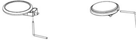
1. ➤ Befestigen Sie die mitgelieferten L-Stücke an den Pads. Ziehen Sie die Flügelmutter an den Pads zunächst handfest an.
