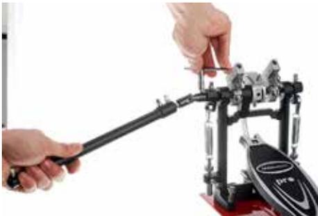
Schritt 2: Kardanwelle an der Fußmaschine (links) befestigen
