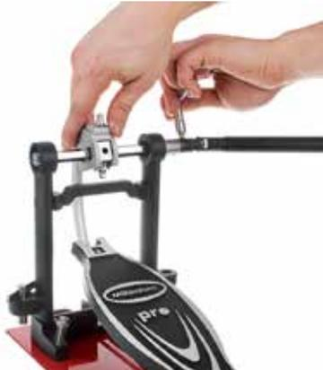
Schritt 4: Aluminium-Scharnier an der Fußmaschine (rechts) einstellen
