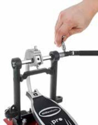
Schritt 3: Aluminium-Scharnier an der Fußmaschine (rechts) einstellen
