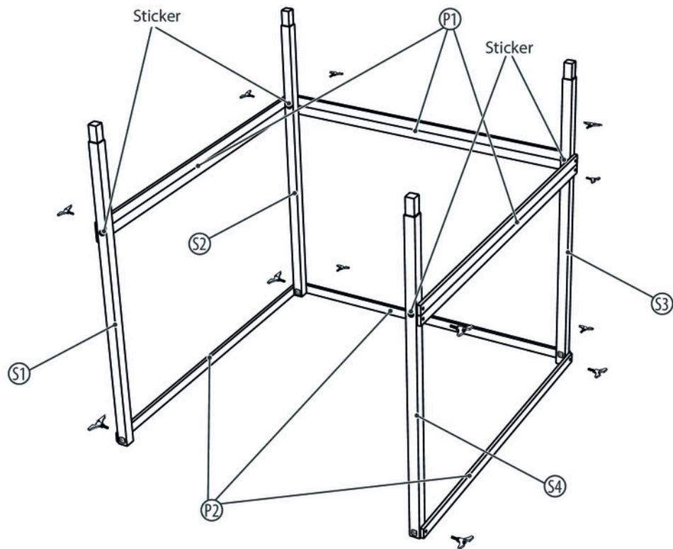
1. ➤ Verbinden Sie S2 und S3 oben mit einem P1 und ziehen Sie die zwei Flügelschrauben leicht an.
