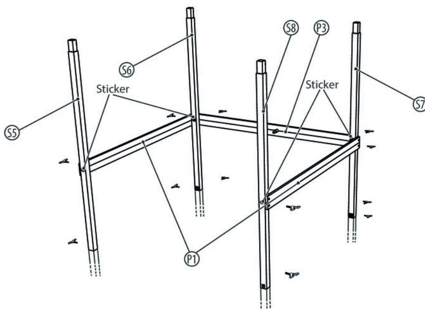
4. ▶ Verbinden Sie S5 und S6 oben mit einem P1 und ziehen Sie die zwei Flügelschrauben leicht an.
