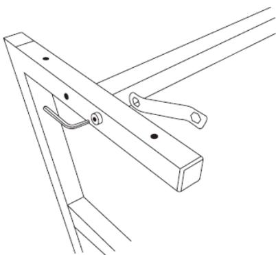
**2.** Montieren Sie die zweite Querstrebe (C) in den beiden Aussparungen im vertikalen Rohr der Z-Standbeine (A). Verwenden Sie die Bolzen (Z1) und Muttern (Z2), um sie wie in Schritt 1 zu befestigen.
