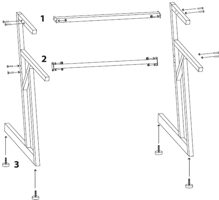
**1.** Verbinden Sie die beiden Z-Standbeine (A), indem Sie eine der Querstreben (C) in den oberen beiden Aussparungen mit den Bolzen (Z1) und den Sicherungsmuttern (Z2) montieren.
