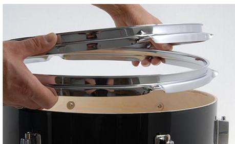
Zum besseren Transport wurden die Spannreifen auf einer Seite des Kessels mit ein paar Schrauben fixiert. Um die Felle aufzuziehen, müssen diese erst einmal komplett entfernt werden. Jetzt wird ein Fell auf den Kessel gelegt, es folgt der Spannreifen. Die beiden Felle und Spannreifen sind gleich, es macht also keinen Unterschied, was wo hin kommt. Ein Blick von oben zeigt, ob das Fell und der Spannreifen auch wirklich mittig auf dem Drum-Kessel aufliegen.
