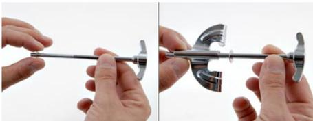
Dazu geht man folgendermaßen vor: Auf die Schraube kommt die Unterlegscheibe und darauf folgt die Spannklau. Wir benötigen 6 Schrauben mit Flügelkopf und 2 mit Vierkant. Die beiden Schrauben mit dem Vierkant kommen auf die Unterseite, also gegenüber der Tom-Halterosette, damit später am Boden genug Freiraum ist.
