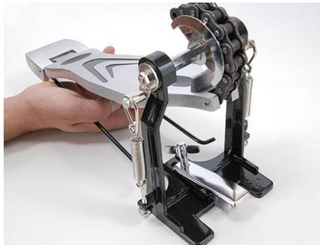
Eigentlich sind es 2 Rundeisenstäbe, die per Federwirkung nach außen drücken. Sie können mit einer Hand zusammengedrückt werden und in die Aussparungen am Rahmen der Fußmaschine gesteckt werden. Hat die Fußmaschine eine Bodenplatte, entfällt dieser Schritt.
