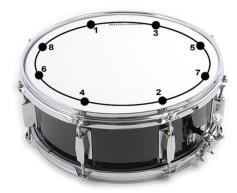
Spannschrauben werden immer über Kreuz angezogen, um eine gleichmäßige Spannung zu gewährleisten. Alle Schrauben sollten gleichmäßig angezogen werden. Am Anfang dreht man die Schraube nicht mehr als eine Umdrehung – zum Ende hin nimmt man  $\frac{1}{4}$  - bis  $\frac{1}{8}$ -Drehungen vor. Dann folgt die Kontrolle des Tons.
