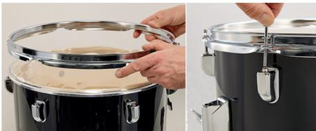
Jetzt wird ein Fell auf den Kessel gelegt, es folgt der Spannreifen. Die beiden Felle und Spannreifen sind gleich, es macht also keinen Unterschied, was wo hin kommt. Ein Blick von oben zeigt, ob das Fell und der Spannreifen auch wirklich mittig auf dem Drum-Kessel aufliegen.
