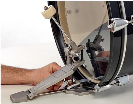
Nun kann die vormontierte Fußmaschine auf den Spannring geschoben und mit der Krallen befestigt werden. Ein bisschen Klebeband schützt den Spannreifen vor Kratzern.
