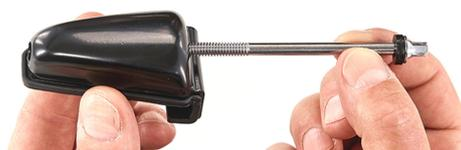
5. ▶ Legen Sie auf 16 Spannschrauben jeweils eine Unterlegscheibe und eine Spannklau.
