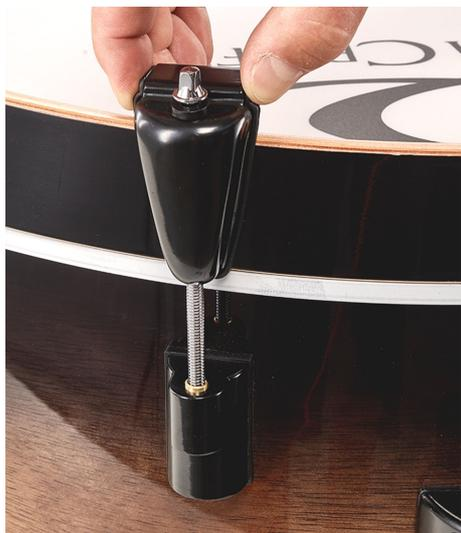
6. ▶ Fixieren Sie 8 Spannschrauben auf dem Spannreifen vom Resonanzfell und ziehen Sie die Spannschrauben kreuzweise leicht an.
